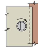
Maçaneta **paralela** à extremidade da porta quando travado
