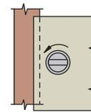
Maçaneta **perpendicular** à extremidade da porta quando travado
