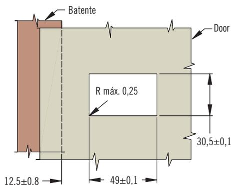
1. Insira a parte dianteira do fecho no furo de instalação e empurre para a frente
