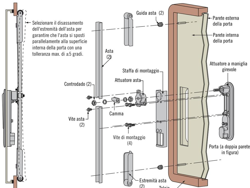
Installazione (Per gli schemi completi dell'installazione visitare [www.southco.com/CR](http://www.southco.com/CR))
