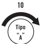
Cierres ensamblado Sentido horario para cerrar
