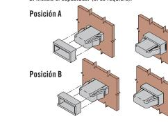
3. Con la guía de posición en su lugar, enganche el retén con el cierre (si las patillas de sujeción están retraídas, empújelas dentro de la carcasa del cierre para soltarlas antes de continuar).
