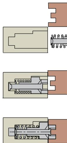
Die Rastmechanik bis zum Anschlag hineinschieben.
