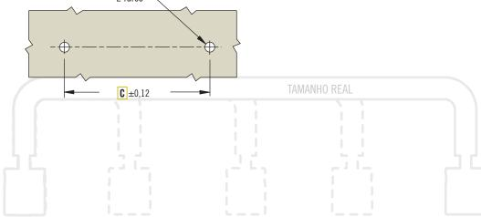
P9 - C - 40 - T B - 1 F - P C Distância entre furos ►P Opções de embalagem **040** 40 mm Omitir para embalagem individual **064** 64 mm (1 por pacote) **096** 96 mm 3 Embalagem em camadas, contate 128 128 mm a Southco ► F Acabamento Anodizado incolor T Rosca∢ B Tipo de base Anodizado preto 08 Rosca imperial 8-32 Rosca interna N M4 Rosca métrica M4 x 0,7 Rosca externa
